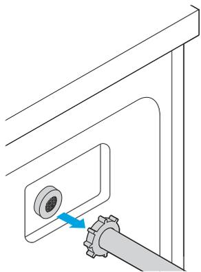
3. Reinigen Sie den Filter mit einer Bürste.
