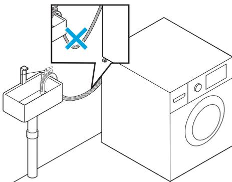
4. Befestigen Sie den Ablaufschlauch mit einer Schnur, einer Schelle oder einem Kabelbinder am Waschbecken.
