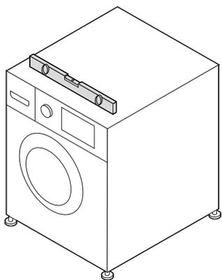
4. Ziehen Sie die Muttern mit einem Schraubenschlüssel an und achten Sie darauf, dass die Maschine ruhig steht.
