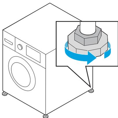
3. Använd ett vattenpass för att kontrollera att tvättmaskinen är rätt justerad och justera fötterna vid behov.
