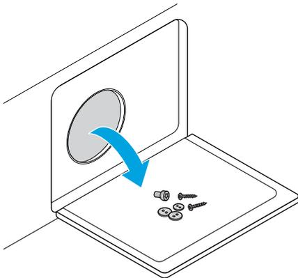
4. Setzen Sie den Filter wieder ein und schließen Sie den Deckel.
