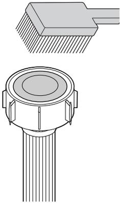
3. Schließen Sie den Wasserzulaufschlauch wieder an den Wasserhahn an und drehen Sie den Wasserhahn auf.
