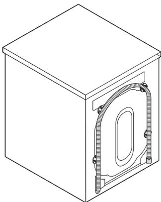
2. Stecken Sie den Ablaufschlauch in den Schlauchhalter.
