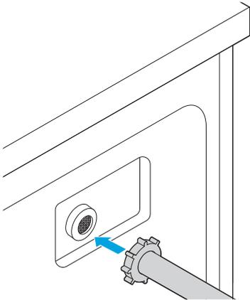
2. Schrauben Sie die Kupplung auf das Gewinde des Hahns, bis sie fest sitzt.
