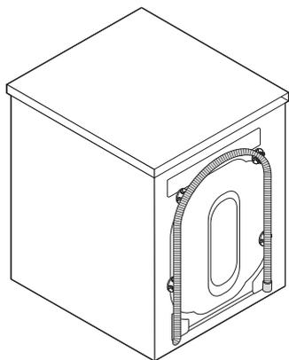
2. Sätt in avloppsslangen i slanghållaren.
