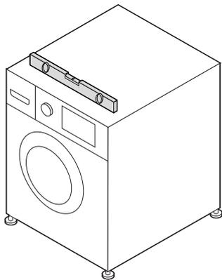
4. Stram møtrikkerne med en skruenøgle, og sørg for, at maskinen står stabilt.
