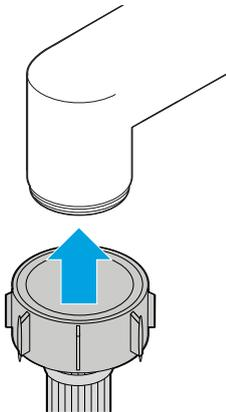
2. Schrauben Sie das Verbindungsstück auf das Gewinde des Wasserhahns.
