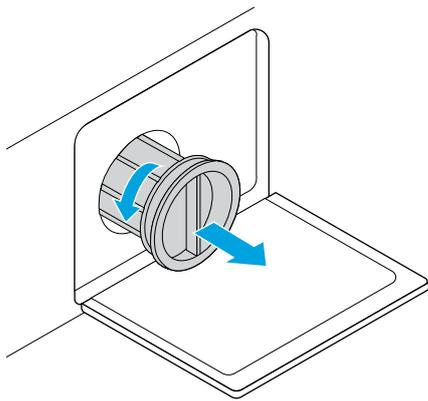
3. Entfernen Sie alle Fremdkörper.
