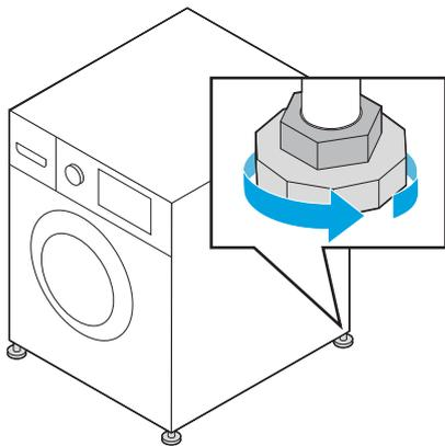
3. Prüfen Sie mit einer Wasserwaage, ob die Waschmaschine perfekt waagrecht steht, und justieren Sie die Füße bei Bedarf neu.
