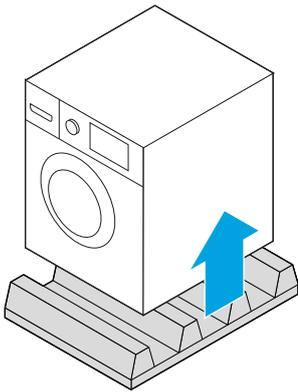
3. Legen Sie das Produkt auf die Seite und entfernen Sie die kleinen dreieckigen Schaumstoffstücke von der Unterseite.
