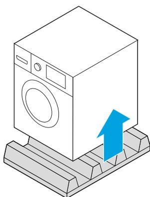
3. Lägg ner maskinen på sidan och ta bort den små triangelformade bitarna med cellplast från undersidan.
