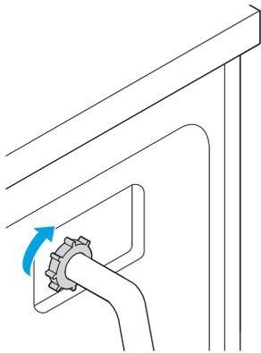
2. Entfernen Sie das Zulaufrohr.
