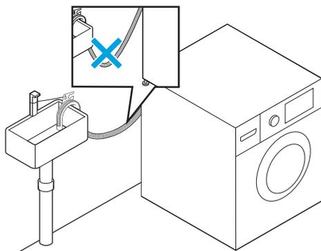
4. Säkra avloppsslangen mot vasken med en rem, klämma eller ett buntband.
