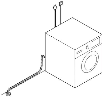
**Schließen Sie den Ablaufschlauch an ein Ablaufrohr des Waschbeckens an.**
